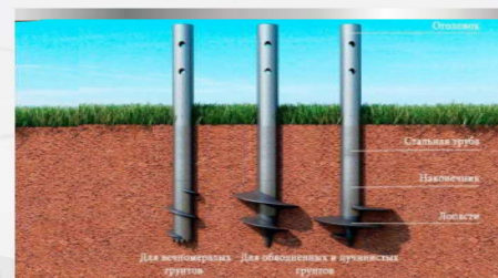
Сваи с наконечниками для вечномерзлых грунтов
