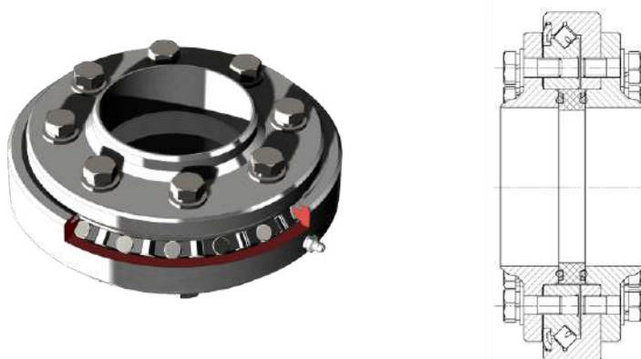
Рис. 22 - Оригинальный роликовый шарнир с уплотнением фторопласт-витон с твердыми рабочими телами из легированных сталей
