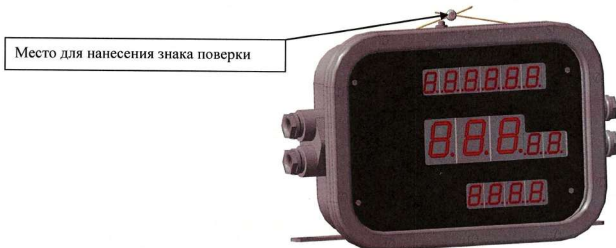
Рисунок 5 – Схема пломбировки электронного блока управления КУП
