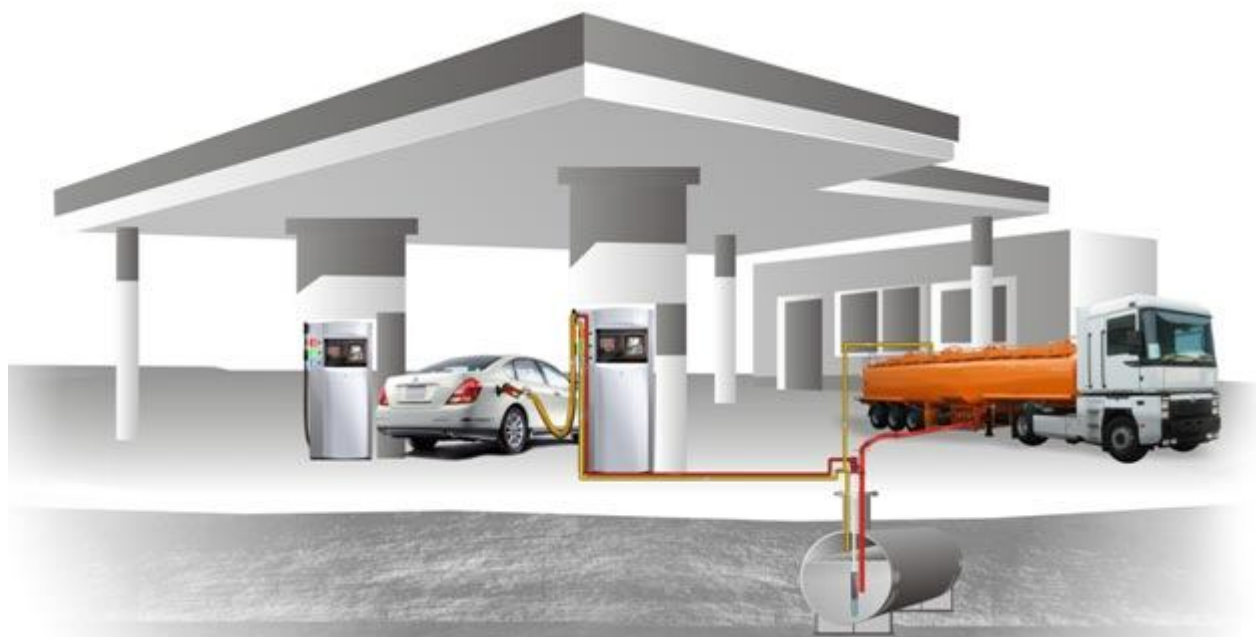
Рисунок 2 - Схема чистой заправки автомобиля и слива продукта из автоцистерны с возвратом паров
