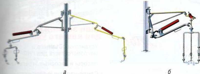
Рис. 2. Устройство для слива и налива железнодорожных цистерн: а – общий вид; б – устройство в рабочем состоянии
